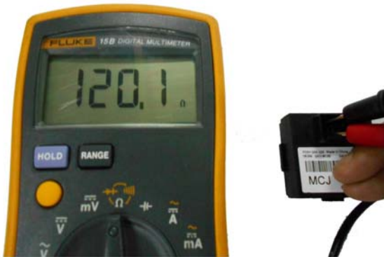
شکل 2-7 روش اندازه گیری مقاومت شبکه های CAN
