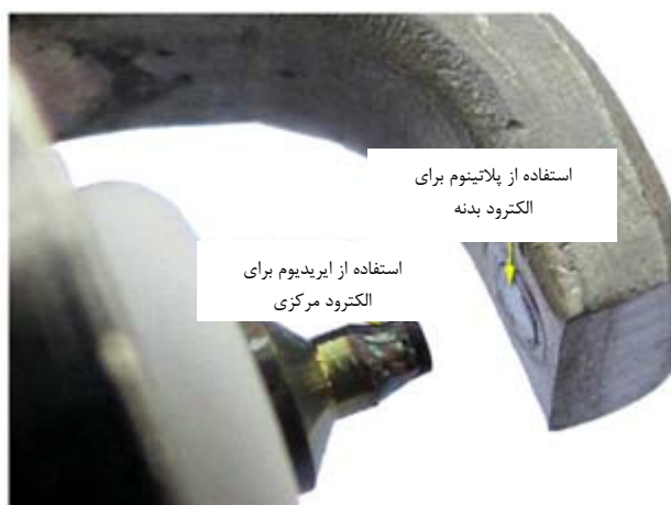
شکل 2-10 استفاده از دو فلز مرغوب برای پلاتین شمع
