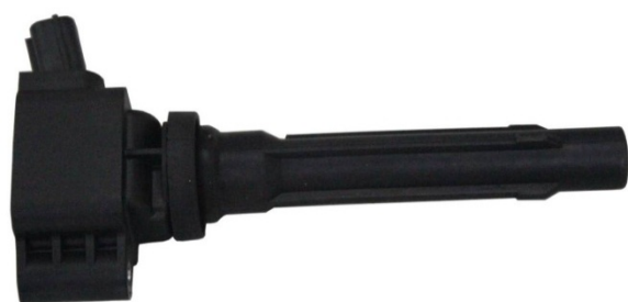
کانکتور کوئل (محل اعمال ولتاژ پایین)
