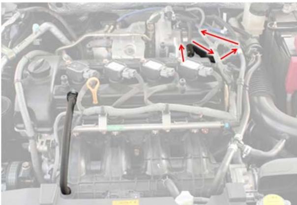
شکل 4-3 کارکرد سیستم تهویه بخارات روغن کارتل در شرایط غیر فعال بودن توربوشارژ
