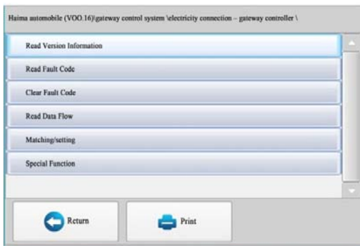
شکل 3-7 منوی عیب یابی gateway در PPT60
