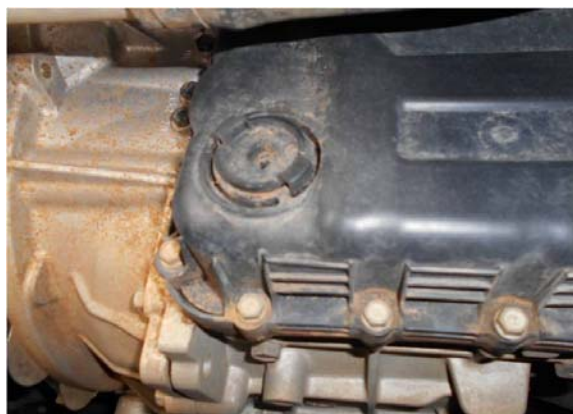
شکل 5-6 پیچ مربوط به بازدید روغن
