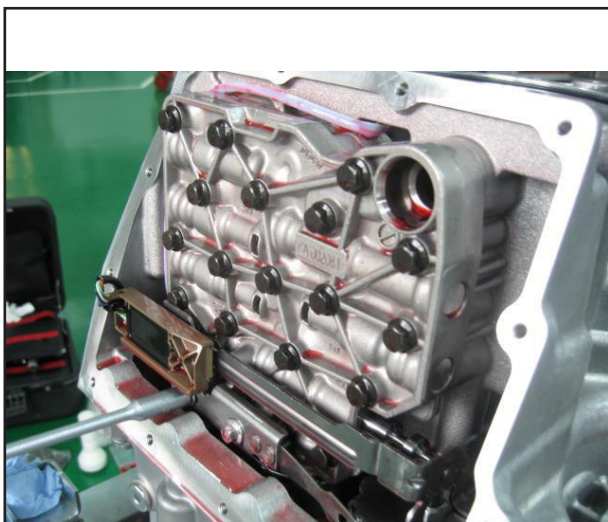
پیچ های سنسور حالت رانندگی را شل کنید
