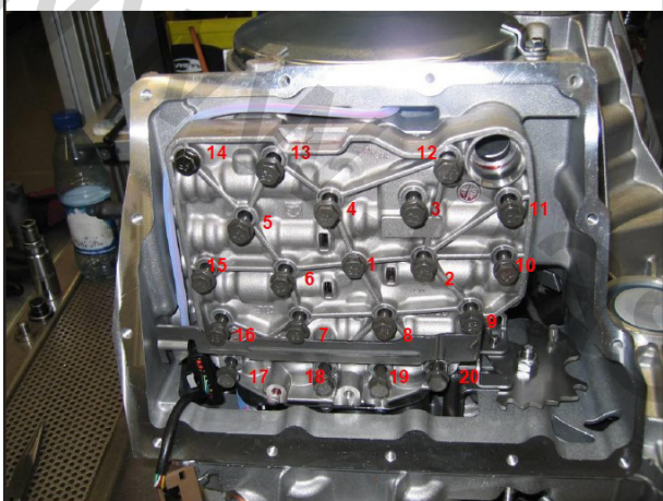
ترتیب باز و بست پیچ ها
