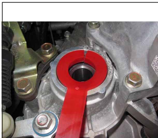
ابزار 102980 نصب شده روی کاسه نمد
