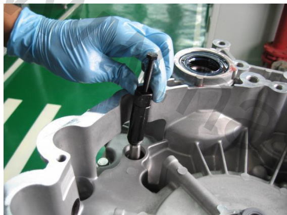
ابزار مخصوص 102970 را روی شفت قرار دهید
