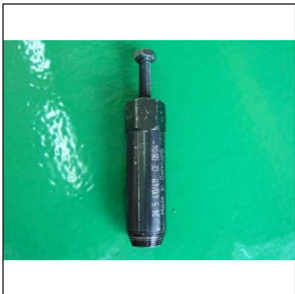
ابزار خارج کننده کاسه نمد شفت انتخاب وضعیت - شماره سریال 102970
