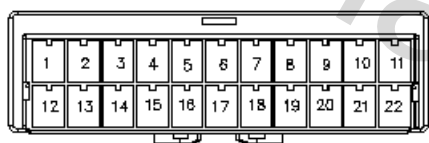
کانکتور دسته سیم اصلی به دسته سیم داشبورد 1 XFTI1
