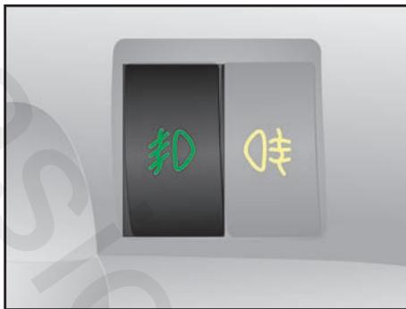
کلید چراغ مه شکن جلو با قرار گرفتن سوییچ در حالت ON و یا روشن شدن خودرو هنگامی که چراغ های کوچک روشن می باشند، می توان این چراغ را روشن کرد. با فشار دادن این دکمه چراغ مه شکن جلو روشن می شود. با فشار دوباره این دکمه چراغ مه شکن جلو خاموش می شود.
