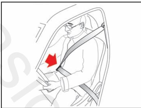
۴- تسمه گذرنده از زیر شکم را طوری تنظیم نمایید که در پایین ترین محل ممکن قرار گیرد تا هنگام بروز تصادف، از لغزش شخص از زیر کمربند جلوگیری شود. کمربند را از سمت شانه به بالا بکشید تا با بدنه فاصله نداشته باشد. جمع کن کمربند بصورت خودکار نیروی کششی اعمال می کند. جهت ایمنی بیشتر کمربند را از بدنه دور ننمایید.
