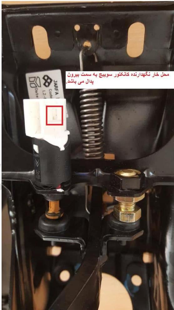
10- چند بار پدال ترمز را فشار داده تا از صحت عملکرد مکانیکی سوییج مطمئن شویم. (آیا کلاهک سوییج به صورت صحیح همزمان با فشردن پدال ترمز باز و بسته می شود یا نه) همچنین از رها کردن پدال ترمز اجتناب گردد. نیروی بیش از 11 N باعث صدمه دیدن سوییج پدال می گردد.
