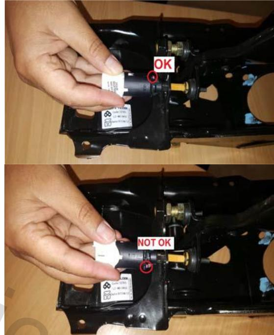
8- در حالی که کلاهک سوییج به استپر متصل می باشد، سوییج را با دست فشار داده تا جایی که بدنه سوییج کاملا روی براکت بنشیند. (کلاهک به اندازه مورد نیاز فشرده و سوییج رگلاز می گردد).
